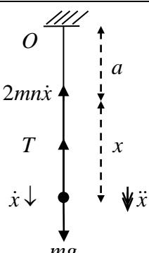
$mg - T - 2mn\dot{x} = m\ddot{x}$ $mg - \frac{2man^2x}{a} - 2mn\dot{x} = m\ddot{x}$ $\ddot{x} + 2n\dot{x} + 2n^2x = g \quad (*)$                                                                                                                                                                                                                                  | M1 A1 A1<br>M1<br>A1 (5)                                        |
